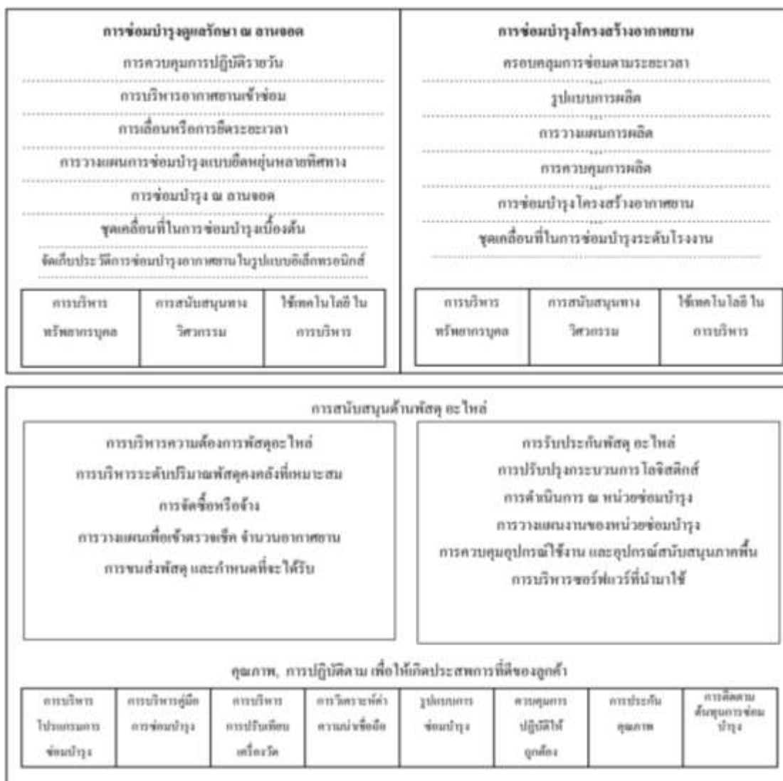
ภาพที่ 2-6 การแบ่งส่วนงานในการดำเนินการซ่อมบำรุงอากาศยาน (ปรับปรุงจาก Kählert, 2017)
